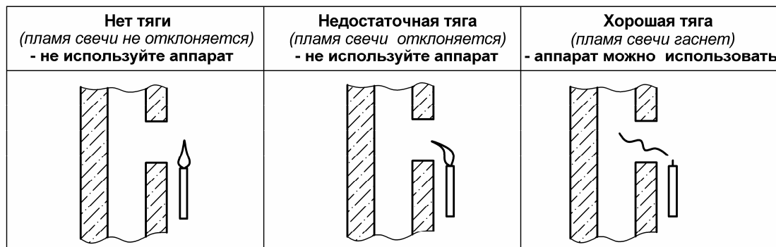
Рисунок 4. Способ проверки тяги в дымоходе
