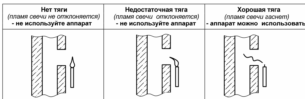
Рисунок 4. Способ проверки тяги в дымоходе
