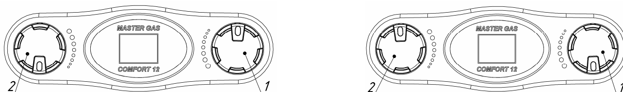
а) Ручки регулировки расхода воды 1 и расхода газа 2 в положении “Минимальный расход”
